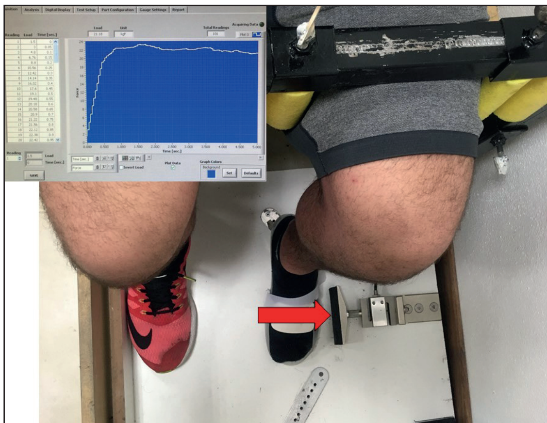
Figura 2. Dinamómetro de diseño y construcción propios para la determinación de la fuerza máxima de la musculatura que provoca la rotación externa y la eversión del pie. Arriba y a la izquierda se expone la curva computarizada que el sistema provee para la determinación del valor máximo obtenido durante un tiempo de contracción voluntaria de 5 segundos.
